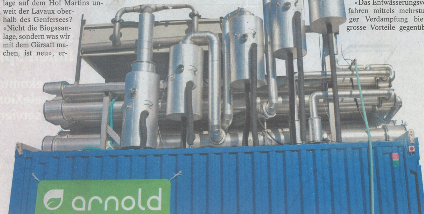
Arbeitet sehr energieeffizient: Der Gärrest-Verdampfer der Arnold & Partner Biogas- und Verfahrenstechnik AG in Puidoux VD.
